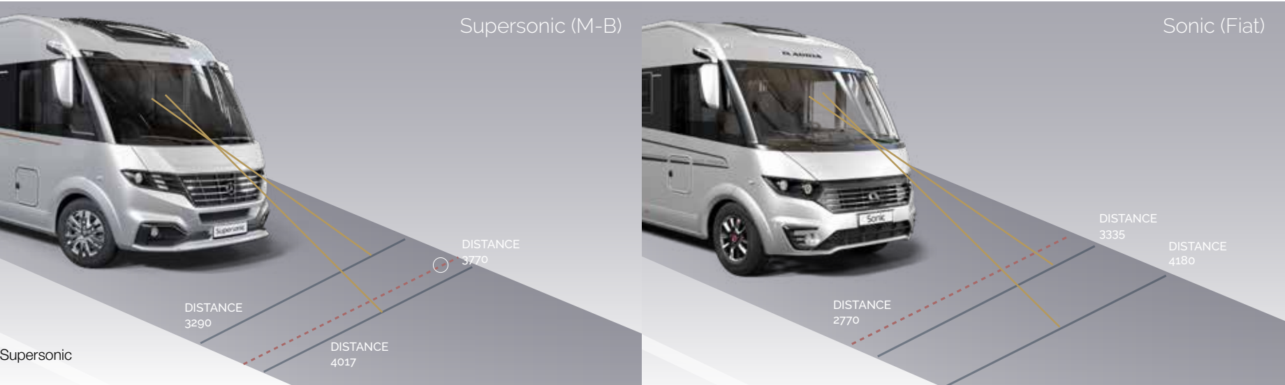
Mercedes-Benz säkerhetsfunktioner med aktiv broms- och avståndsassistans DISTRONIC (standard).
