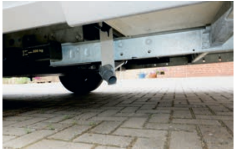
Das gut sicht- und erreichbare Abflusrohr des Grauwassertanks wird über den Schalter am Armaturenbrett geöffnet.
