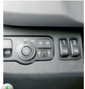
+ Schalter für die Frisch- und Abwasserentleerung.
